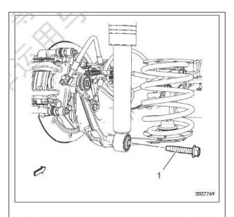
3. 安装新的下减振器螺栓(I),并紧固至150牛米(111英尺磅力)+60°。
