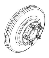
手册规定,在测量制动盘时要正确固定制动盘,车轮螺母的紧固扭矩为140N•m。为减少反复拆装对车轮螺母和螺栓造成的损害,比赛时车轮螺母的紧固力矩规定为20N•m,但在最后的车轮安装时必须达到规定扭矩。
