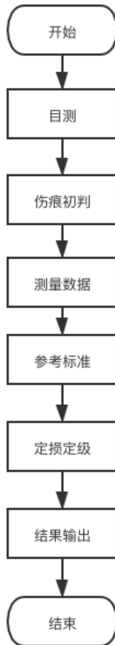
图 A.1 受损汽车外部照明装置现场勘验流程
